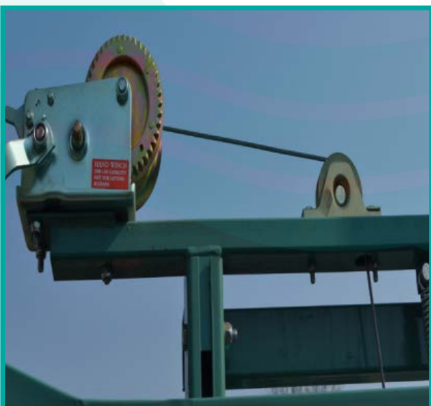
Verricello sollevatore della barra Winch lifting the booms
