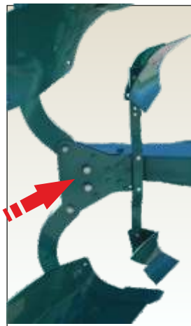
Bullone di sicurezza a taglio Shear bolt safety device
